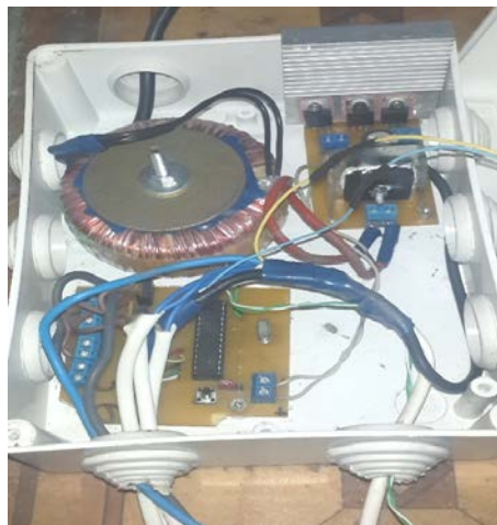
Рис.3 Виготовлена та змонтована система управління освітленням
