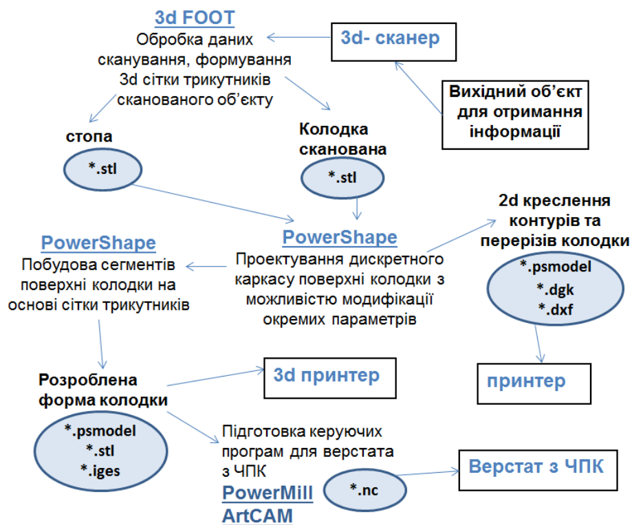
Рис. 3.20. Алгоритм процесу проектування та виготовлення форми
