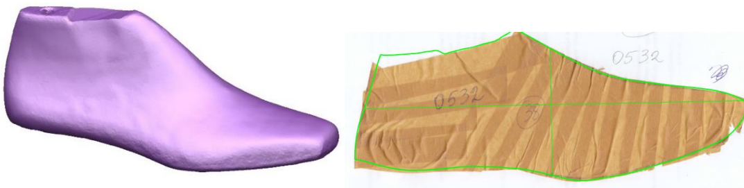
Рис. 6.5 (а) - 3д модель сканованої колодки та розгортки поверхні, отримані ручним способом та за допомогою САПР
