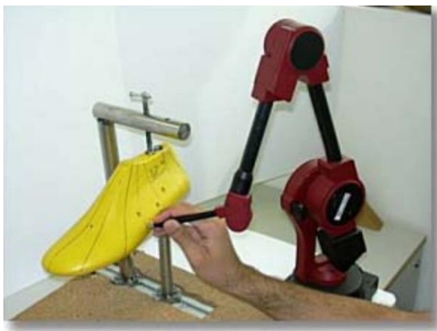
Рис. 2.3. 3D-сканування взуттєвої колодки за допомогою координатно-вимірального пристрою
