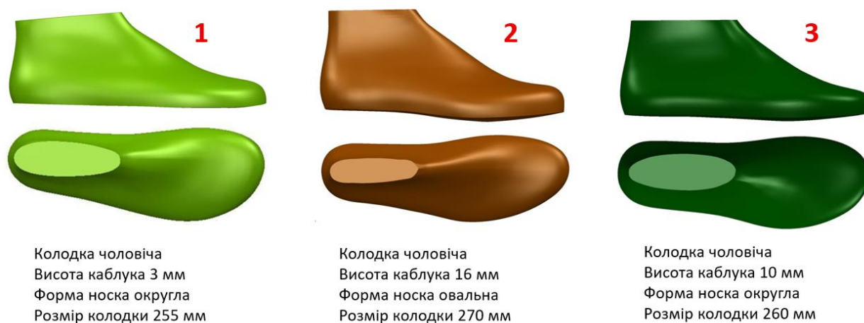
Рис. 6.5 (б). Колодки, задіяні в експерименті, та їх ручні розгортки
