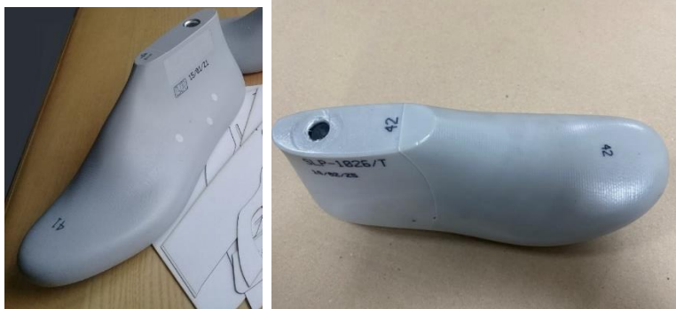
Рис. 5.8. Стандартна колодка, що використовувалася на підприємстві (зліва) та вдосконалена колодка (справа).
