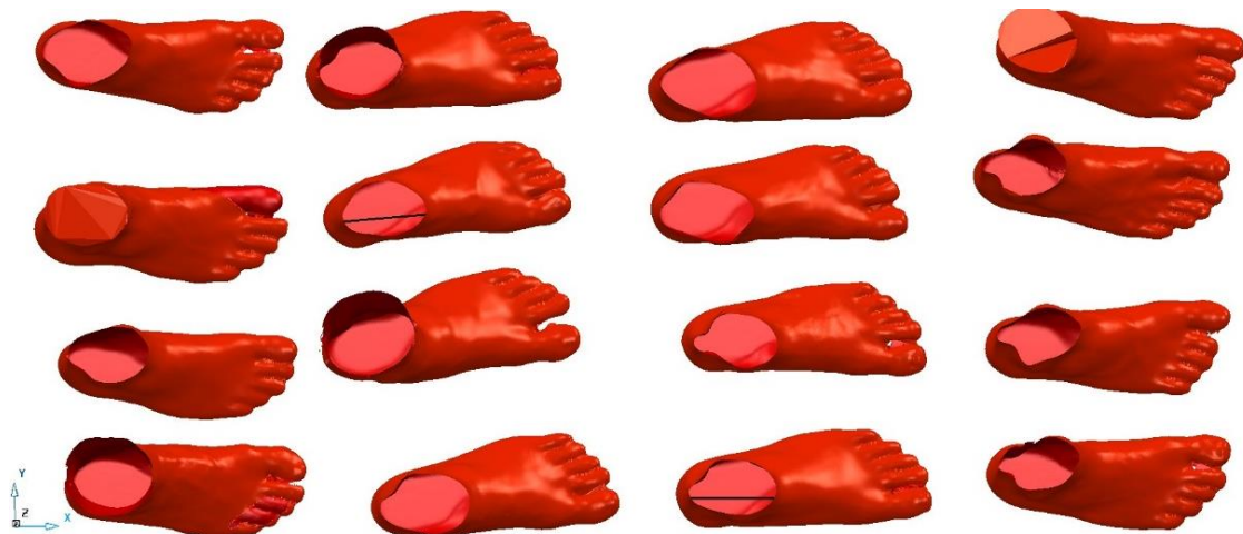
Рис. 3.14. Фрагмент зразка стопи цільової групи споживачів, дослідженого методом 3D сканування
