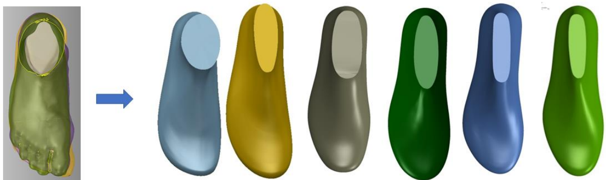
Рис. 4.30. Розробка бази ергономічних форм колодок для комфортного взуття
