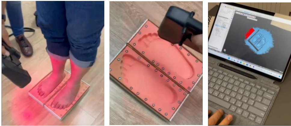
Рис. 3.8. 3D-скан стопи, поміщеної в пінопластовий бокс.
