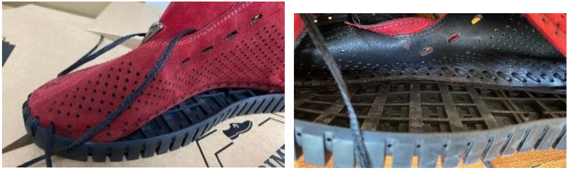
Рис. 5.3. Приєднання заротовки верху до підошви нитковим швом
