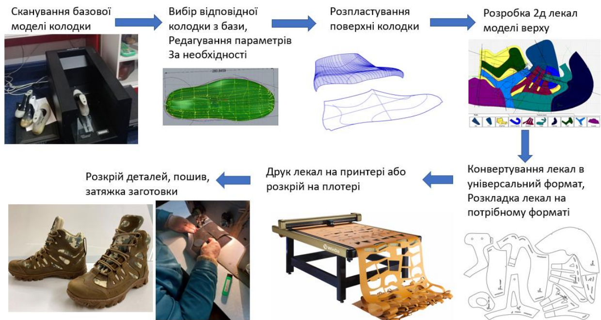
Рис. 6.1. Алгоритм процесу розробки та виготовлення цифрового проєкту в умовах взуттєвого виробництва на прикладі моделі тренувальних берців
